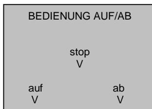
Drücken Sie die -Taste und kontrollieren Sie, ob die Markise hinausfährt. Wenn nicht, so müssen am Motor, der braune und der schwarze Draht vertauscht werden. Kontrollieren Sie danach nochmals die Drehrichtung mit der -Taste.
