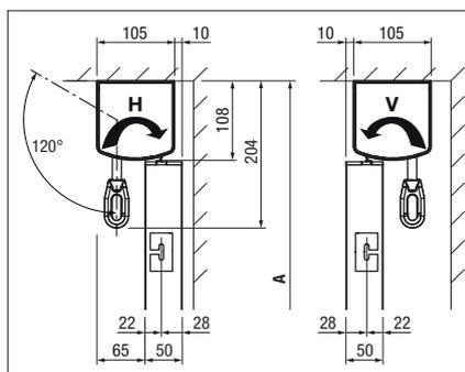
Montaggio a soffitto con guida laterale monopezzo (montaggio diretto)
