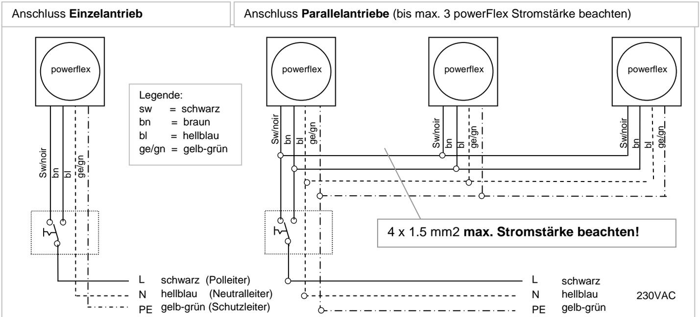
Elektrische Anschlüsse so ausführen, dass sie jederzeit **zugänglich und abschaltbar** bleiben. Diese Kabelverbindungen müssen den Mindestschutzgrad **IP 54** aufweisen:
