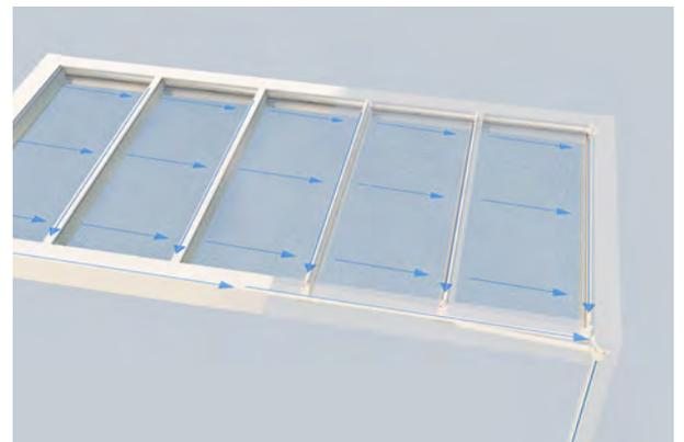
Die schrägen Dachelemente leiten Regen in das STOBAG Ablaufsystem, das clever im Rahmen und in den Stützen integriert ist. Eine aufgesetzte Regenrinne ist daher nicht nötig.
