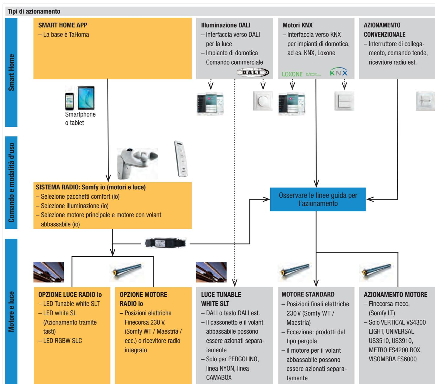
STOBAG mette a disposizione interfacce per alcuni prodotti selezionati, per consentire il passaggio più agevole possibile a un sistema di controllo degli edifici. Grazie alle interfacce DALI o KNX integrate nelle tende da sole, nelle pergole o nelle coperture in vetro, lo sforzo di progettazione è ridotto al minimo e il cablaggio è semplificato per l'installatore elettrico.
