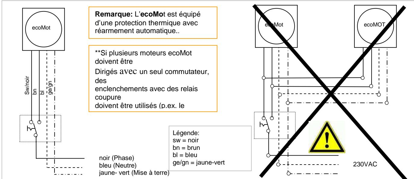
Choisissez les raccordements électriques de façon à ce qu'ils restent à tout moment accessibles et débrayables. Ces liaisons cablées doivent avoir la classe de protection **IP 54** (ecoMot = IP 44):
