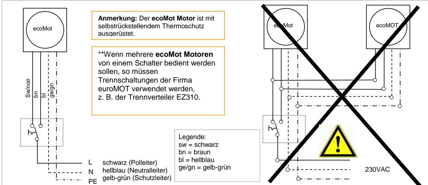
Elektrische Anschlüsse so ausführen, dass sie jederzeit **zugänglich und abschaltbar** bleiben.
