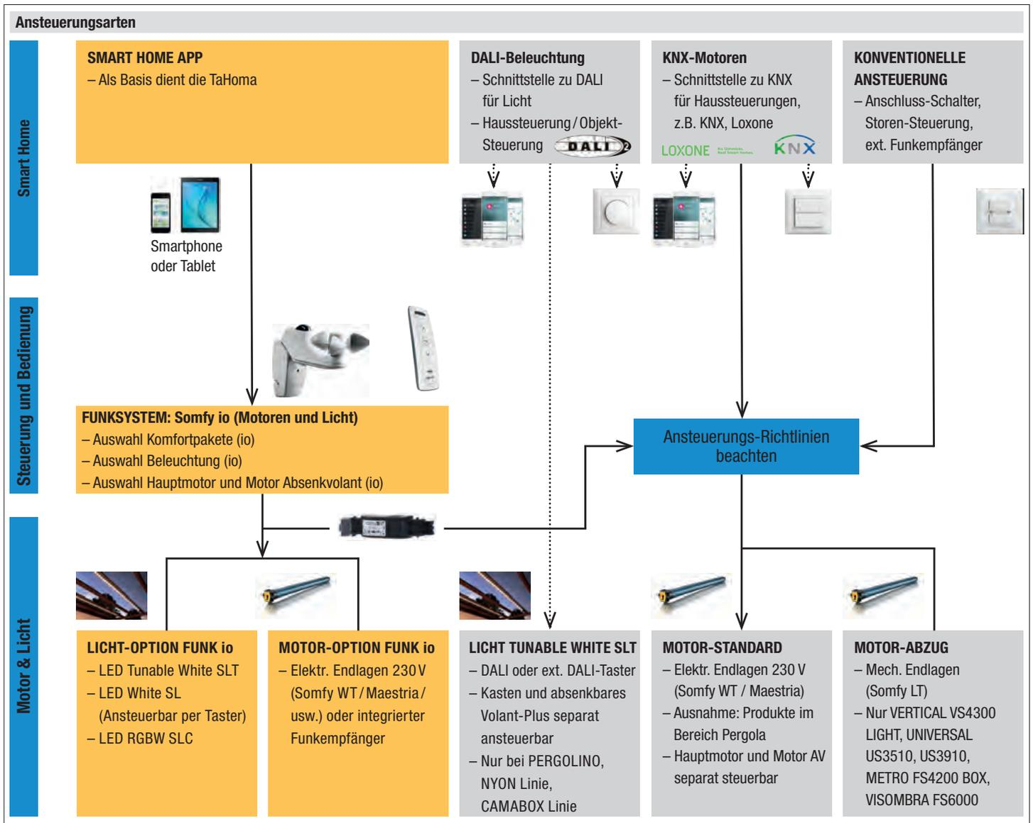
STOBAG stellt bei ausgewählten Produkten Schnittstellen bereit um einen möglichst reibungslosen Übergang an eine Gebäudesteuerung zu ermöglichen. Dank der in Markisen, Pergolen oder Glasdächern integrierten DALI- oder KNX-Schnittstellen wird der Planungsaufwand minimiert und die Verkabelung für den Elektroinstallateur vereinfacht.
