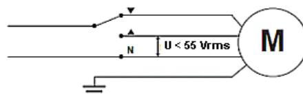
9. Les moteurs WT Somfy ne doivent pas être commandés via des relais statiques (solid state relais).
