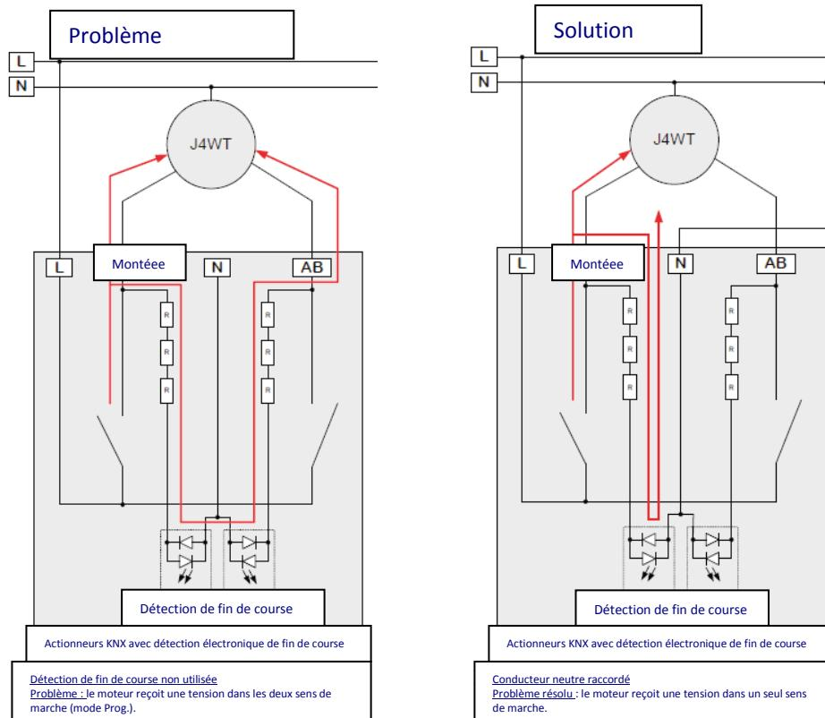
Le raccordement du conducteur neutre à l'actionneur sert en l'occurrence de point de mesure nécessaire. Dans ce cas, chaque borne N (point de mesure au niveau de l'actionneur) et chaque conducteur neutre de moteur doivent obligatoirement être associés au potentiel de conducteur neutre (rail N).
