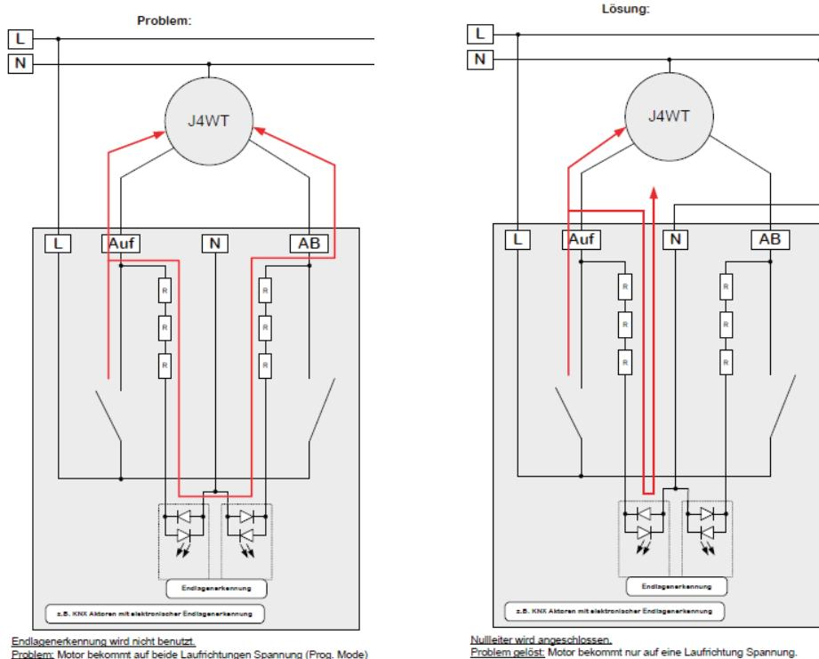
Dabei dient der Neutralleiteranschluss am Aktor als notwendiger Messpunkt. In diesem Fall muss zwingend jede N-Klemme (Messpunkt am Aktor) und jeder Antriebsneutralleiter auf Neutralleiterpotential (N-Schiene) gelegt werden.
