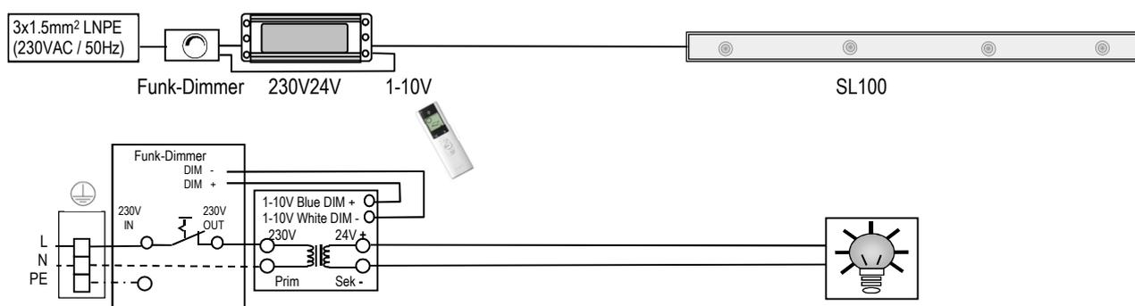
**Wichtig: Pro Funkempfänger darf max. 1 Netzeinheit oder Netzgerät angeschlossen werden.**
