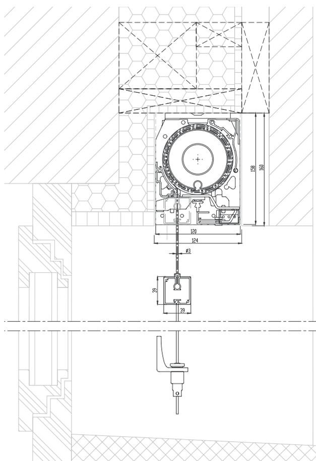
Installazione a soffitto con guida a cavetto,
