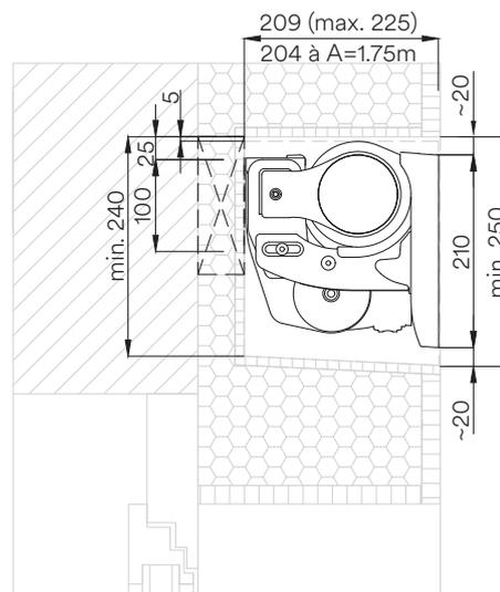
Coupe d'une variante de montage et de niche, angle d'inclinaison 0° – 5°, façade crépie
