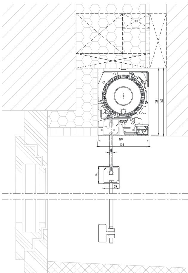
Montage au plafond avec guidage par tige,
