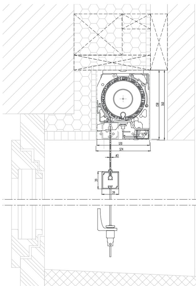
Montage au plafond avec guidage par câble
