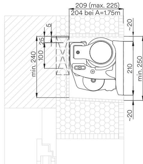
Schnitt einer Einbau- und Nischenvariante,
