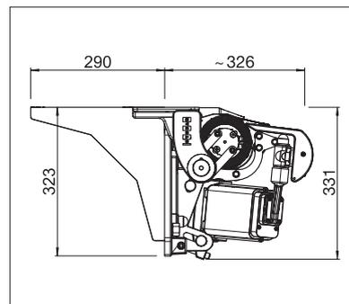
Deckenmontage mit Deckenwinkel
