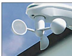
En caso de disponer de un sistema de mando, se debe revisar periódicamente el sensor de viento mecánico para excluir daños por influencias externas y su capacidad de funcionamiento (observar el comportamiento de giro con viento). Si el sensor de viento no gira bien, tendrá que ser revisado por un técnico de STOBAG.
