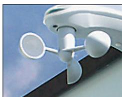
Als er een besturingssysteem aanwezig is, moet de mechanische windsensor periodiek op beschadigingen door externe invloeden danwel op zijn functionaliteit gecontroleerd worden (draaggedrag bij wind observeren). Mocht de windsensor niet juist draaien, dan moet deze door een STOBAG dealer gecontroleerd worden.
