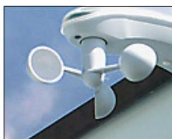
Si un automatisme est prévu, il faut contrôler périodiquement le fonctionnement de l'anémomètre et les éventuels dégâts causés par des influences extérieures (observer le tournoiement lors du vent). Si l'anémomètre ne tourne pas correctement, il faut aviser le storiste agréé STOBAG.
