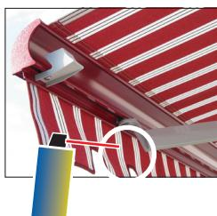
In principe hebben de mechanische delen weinig onderhoud nodig. Het af en toe smeren van de uitvalprofielbevestiging met een geschikt smeermiddel (bv. WD40®) en periodieke controles / onderhoudswerkzaamheden door een STOBAG-dealer worden aanbevolen en kunnen de levensduur van het zonnescherm verlengen.
