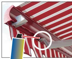
En général, les composants mécaniques ne demandent presque pas d'entretien. Un graissage occasionnel de la fixation de la barre de chute avec un produit adapté (p.ex. WD40®) ainsi qu'un contrôle périodique/entretien par un storiste agréé STOBAG sont recommandés et peuvent prolonger la durée de vie du store.
