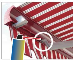
Grundsätzlich sind die mechanischen Teile wartungsarm. Gelegentliches Schmieren der Ausfallprofilbefestigung mit einem geeigneten Schmiermittel (z.B. WD40®) sowie periodische Kontrollen/Wartungen durch einen STOBAG Fachbetrieb wird empfohlen und kann die Lebensdauer der Markise verlängern.
