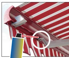
En principio, las piezas mecánicas no requieren ningún tipo de mantenimiento. Se recomienda lubricar ocasionalmente la fijación del perfil de caída con un lubricante adecuado (p. ej. WD40®) así como encargar a un establecimiento especializado STOBAG que realice revisiones y/o mantenimientos periódicos, ya que de este modo se puede prolongar la vida útil del toldo.
