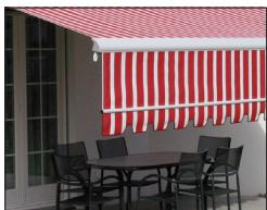
Das VOLANT-PLUS (absenkbares Volant; nicht bei allen Modellen verfügbar) wird mittels Handkurbel ausgefahren. Je nach Montageseite des Getriebes ändert die Auf- / Abrollrichtung. Falls sich das Fallprofil nicht vollständig zum Volantprofil einfahren lässt, muss das VOLANT-PLUS nochmals ganz ausgefahren und in entgegengesetzter Richtung erneut eingefahren werden.
