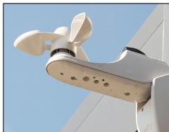
Gli anemometri meccanici ed elettrici installati non richiedono manutenzione. Consultare le istruzioni per l'uso dei sensori. L'anemometro meccanico deve essere controllato regolarmente per verificarne il corretto funzionamento (osservare la rotazione in condizioni di vento).
