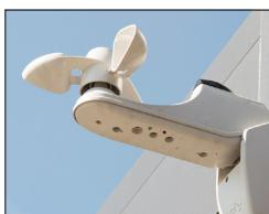
Les capteurs de vent mécaniques et électriques installés ne nécessitent aucun entretien. Pour cela, veuillez consulter les modes d'emploi des capteurs. Il convient de vérifier régulièrement le bon fonctionnement du capteur de vent mécanique (observer le comportement de rotation en cas de vent).
