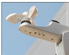
De geïnstalleerde mechanische en elektrische windsensoren zijn onderhoudsvrij. Raadpleeg hiervoor de handleiding van de sensoren. De mechanische windsensor moet regelmatig worden gecontroleerd om er zeker van te zijn dat hij goed werkt (let op het draaigedrag bij wind).
