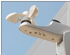
Die verbauten mechanischen und elektrischen Windsensoren sind wartungsfrei. Dazu bitte entsprechend die Bedienungsanleitungen der Sensoren beachten. Der mechanisch Windsensor sollte regelmässig auf seine Funktionsfähigkeit hin überprüft werden (Drehverhalten bei Wind beobachten).
