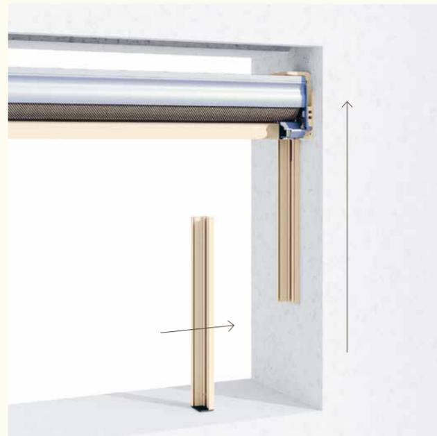
La guida divisa facilita notevolmente il montaggio, ideale per nicchie strette, per l'installazione dietro protezioni anticaduta esistenti o dall'interno. La guida posteriore divisa al centro rimane nascosta dalla guida anteriore continua e garantisce un aspetto armonioso. Particolarmente pratico per il montaggio a innesto quando lo spazio disponibile è limitato.
