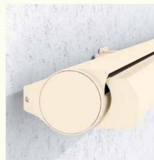
Il guscio protettivo Protect trasforma la tenda in una tenda semi casonata. Il tessuto per tende è completamente protetto mentre i bracci della tenda si trovano all'esterno del casonetto di protezione. Questa struttura fornisce una protezione equilibrata dagli agenti atmosferici. Inoltre, i canali di scarico interni convogliano l'acqua piovana verso l'esterno quando la stoffa è avvolta.
