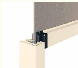
La guida zip offre la massima stabilità al vento, una tensione costante del tessuto e protezione senza fessure dal sole e dall'abbagliamento, o anche protezione dagli insetti. I binari guida laterali mantengono la tenda saldamente in posizione anche in caso di vento forte, senza sbatacchi fastidiosi.
