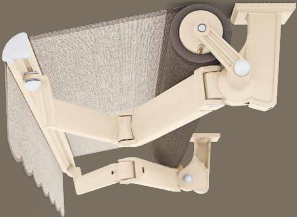
SIGMA Montage sous dalle Store à bras articulés compact, construction ouverte et sans tube porteur. Palier combiné pour le montage sous dalle, fixation des bras et support de tube d'enroulement. Bras articulés avec profilés en aluminium extrudé et ressorts intégrés. Palier combiné avec sécurité anti-rabattement et angle de chute réglable jusqu'à 68°.
