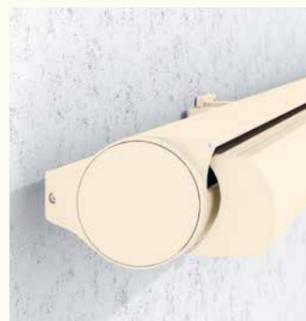
Die Protect Schutzhülse verwandelt die Markise in eine Halbkassettenmarkise. Das Markisentuch ist rundum geschützt, während die Markisenarme ausserhalb der Kassette liegen. Diese Konstruktion bietet einen ausgewogenen Schutz vor Witterungseinflüssen. Zudem sorgen innenliegende Ablaufkanäle dafür, dass Regenwasser bei eingerolltem Tuch gezielt nach aussen abgeleitet wird.
