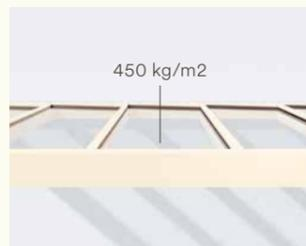
VETRO FINO ist für hohe Lasten bis zu 450 kg/m<sup>2</sup> ausgelegt und kann an örtliche Schneelasten angepasst werden. Die stabile Konstruktion gewährleistet dauerhaften Wetzschutz, wodurch der Aussenraum auch im Winter ein komfortabler Rückzugsort bleibt.
