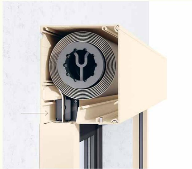
Bei einer Senkrechtmarkise mit versenktem Fallprofil bleibt die Kassette im eingefahrenen Zustand kompakt und geradlinig. Das sorgt für eine klare Fassadengestaltung, schützt das Tuch und bewahrt die Komponenten vor äusseren Witterungseinflüssen. Die geschlossene Konstruktion erhöht zudem die Langlebigkeit der Markise.
