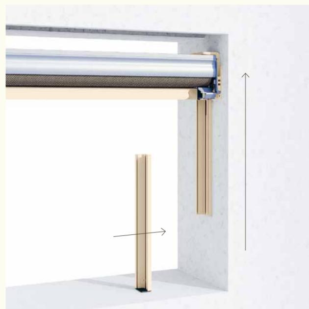
Die zweiteilige Führungsschiene erleichtert die Montage erheblich – ideal für schmale Nischen, Absturzsicherungen oder den Einbau von innen. Dank der mittigen Teilung des hinteren Profils bleibt die sichtbare Führung durchgehend und sorgt für eine harmonische Optik. Besonders praktisch bei aufgesteckter Montage, wenn wenig Platz zur Verfügung steht.
