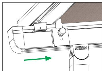
**▲** Die Markise mit der AUF-Taste in die Ausfallprofil-Arretierung einfahren, bis der Motor abstellt.
