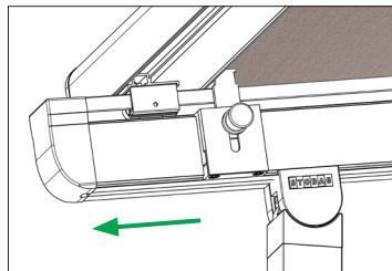
Die Markise mit der AB-Taste ausfahren, bis die Ausfallprofil-Arretierung bedient werden kann.
