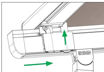
2. Scherm schuift terug en de vergrendeling wordt automatisch geblokkeerd – het doek wordt gespannen.
