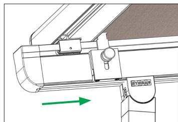
**▲** Arretrare la tenda con il tasto SU in modo che si inserisca nel blocco del frontalino, fino all'arresto del motore.
