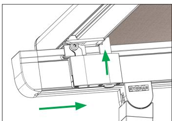
2. Markise fährt zurück und Arretierung wird automatisch blockiert – Tuch wird gespannt.
