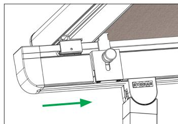
**▲** Scherm met de OMHOOG-toets in de uitvalprofielvergrendeling schuiven, totdat de motor uitschakelt.
