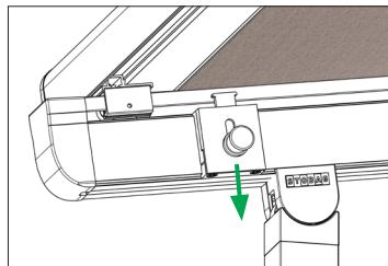
Alle Ausfallprofil Arretierungen lösen (beidseitig, an allen Führungen).
