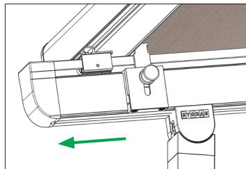
▼ Scherm uitschuiven met de AB-toets, totdat de uitvalprofielvergrendeling kan worden bediend.
