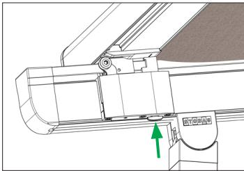
La glissière se trouve au niveau de la rampe, enclencher de nouveau le crochet de traction.
