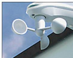
Als er een besturingssysteem aanwezig is, moet de mechanische windsensor periodiek op beschadigingen door externe invloeden danwel op zijn functionaliteit gecontroleerd worden (draagedrag bij wind observeren). Mocht de windsensor niet juist draaien, dan moet deze door een STOBAG dealer gecontroleerd worden.
