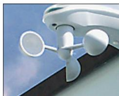
En caso de disponer de un sistema de mando, se debe revisar periódicamente el sensor de viento mecánico para excluir daños por influencias externas y su capacidad de funcionamiento (observar el comportamiento de giro con viento). Si el sensor de viento no gira bien, tendrá que ser revisado por un técnico de STOBAG.
