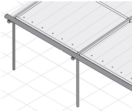
L'eau de pluie s'écoule de la toile tendue soit par les œillets d'eau perforés (PERGOLINO), soit dans le canal d'eau au niveau de la barre de charge.
